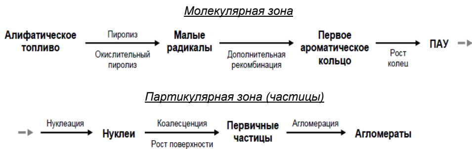
Рис. 5. Схема формирования сажи
